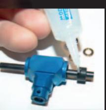
Die im Rotorkopf befindlichen und Axiallager sollten regelmäßig gefettet werden
