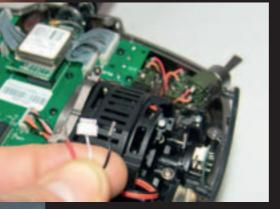
Bei der DX8 muss für Leerlauf vorn das entsprechende Pitchpoti umgepolt werden (siehe Text)
