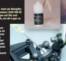
Beim Check sollte auch die Heckrotor-Schiebehülse nicht vergessen werden. Hier bietet sich dünnflüssiges, fein dosierbares Spezialöl an, nachdem die Bauteile sorgfältig gesäubert wurden
